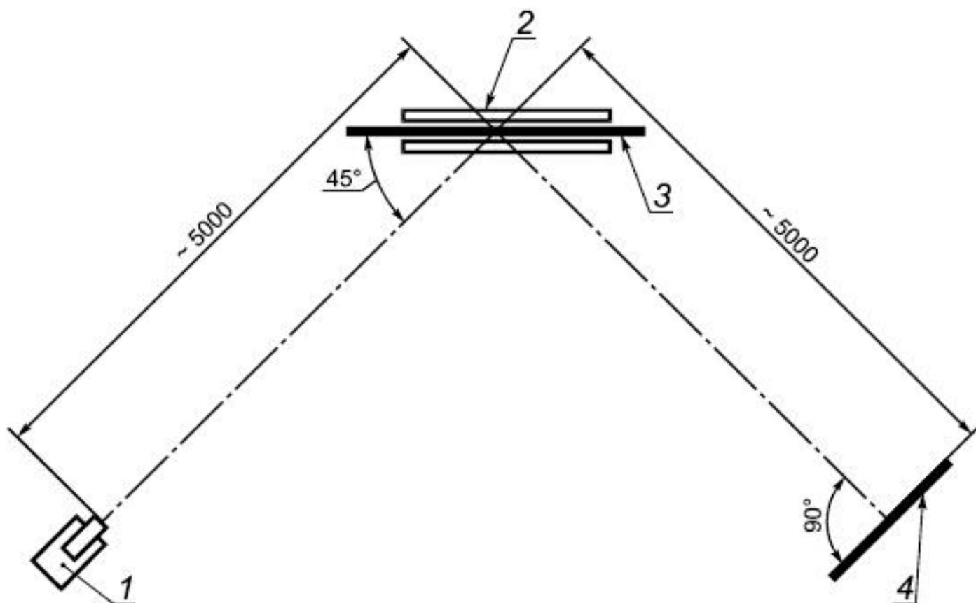
1 - диапроектор с растром; 2 - держатель образцов; 3 - образец зеркала; 4 - экран
